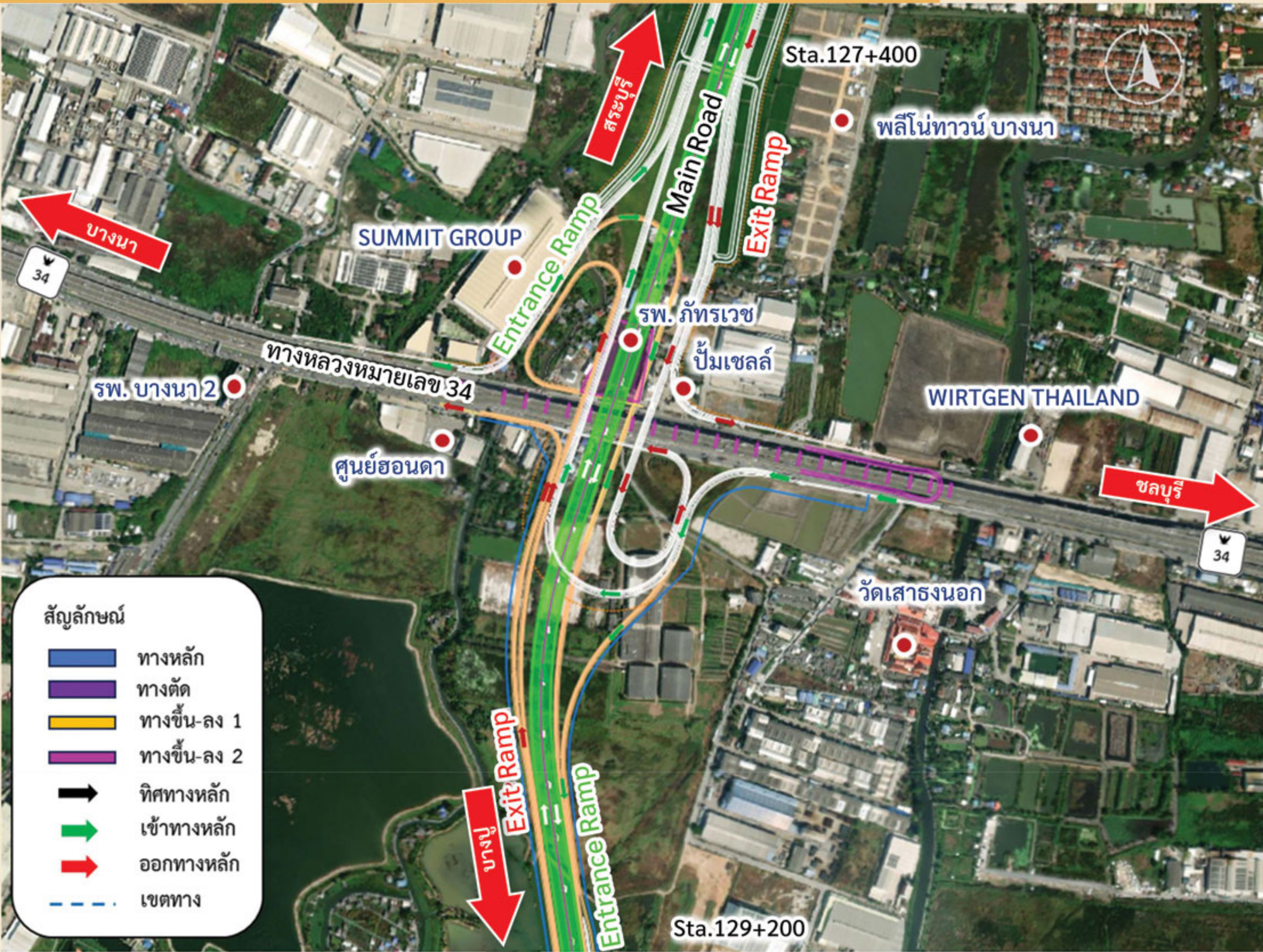
รูปแบบที่ 1 : Partial Cloverleaf ดั้งเดิม (ปี 2562)
